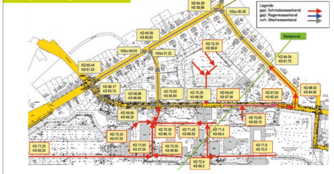
Trennsystem: Ableitung des Schmutzwassers
