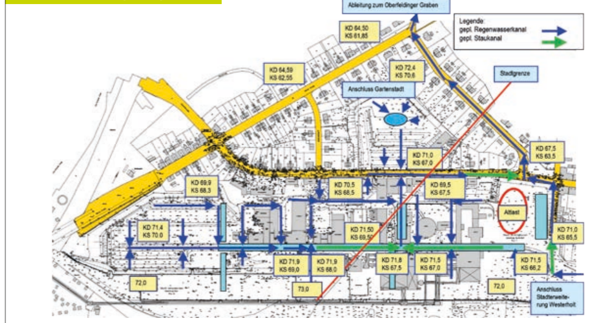
Trennsystem: Ableitung des Regenwassers
